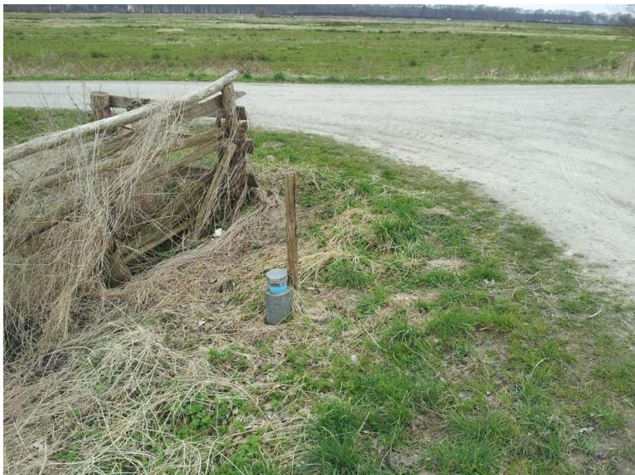
**Abbildung 6: Grundwassermessstelle GWM 2 in der Nordost-Ecke des Untersuchungsgebietes.**
