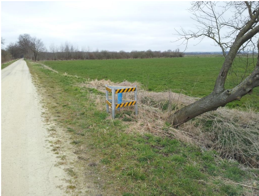
Abbildung 7: Grundwassermessstelle GWM 3 in der Südost-Ecke des Untersuchungsgebietes.
