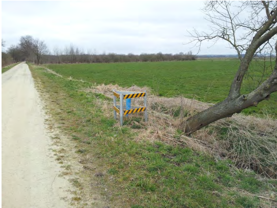
Abbildung 7: Grundwassermessstelle GWM 3 in der Südost-Ecke des Untersuchungsgebietes.
