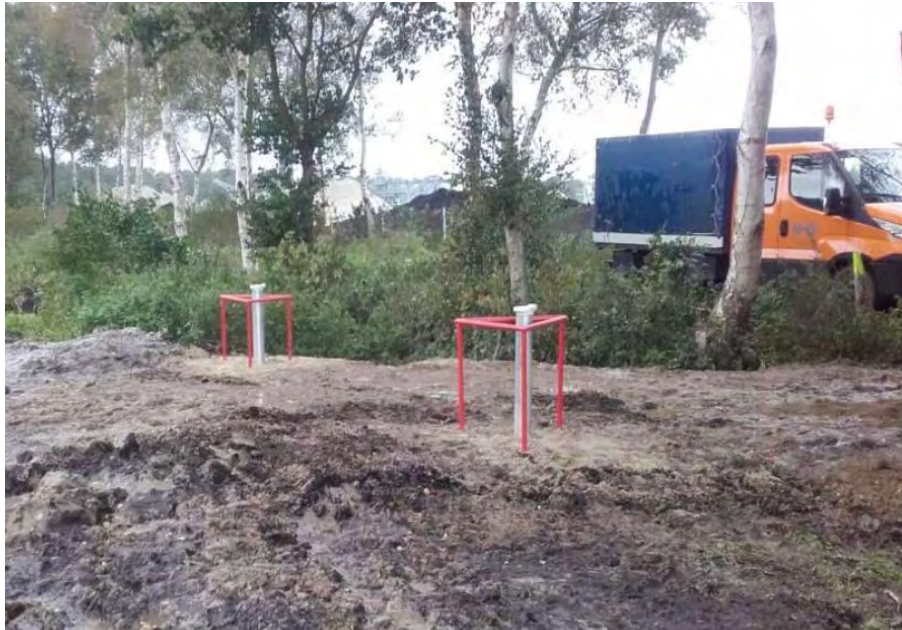
Abbildung 9: Grundwassermessstellen GWM 5 (F) und GWM 5 (T) im Zentrum des Untersuchungsgebietes.
