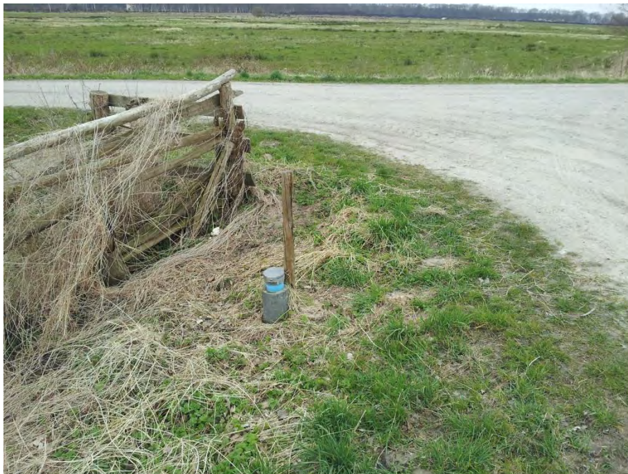
Abbildung 6: Grundwassermessstelle GWM 2 in der Nordost-Ecke des Untersuchungsgebietes.
