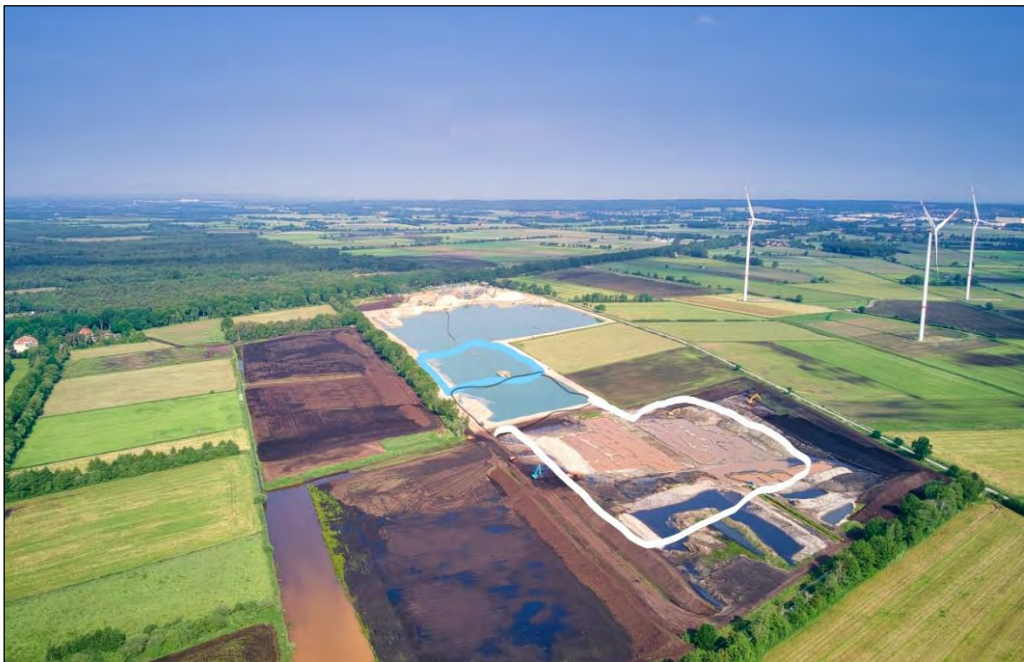
Abbildung 6: Aktueller Stand des Nassabbaus in der Abbaustätte Schwegermoor (hellblaue Umrandung: im Frühjahr 2021 abgebaut; dunkelblaue Umrandung: bis August 2021 abgebaut; weiße Umrandung: ab Mitte August 2021 abgebaut [gem. schriftl. Mitteilung HKS vom 10.12.2021])
