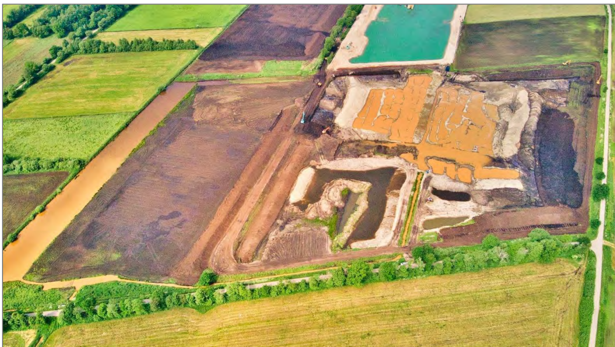
Abbildung 3: Detailaufnahme der östlichen Teilflächen im nördlichen Abbaufeld am 09.06.2021. Die Aufnahme zeigt die z.T. bereits abgetorften Flächen und den beginnenden Abbau des mineralischen Unterbodens vor der Fortführung der Nassauskiesung nach Osten.
