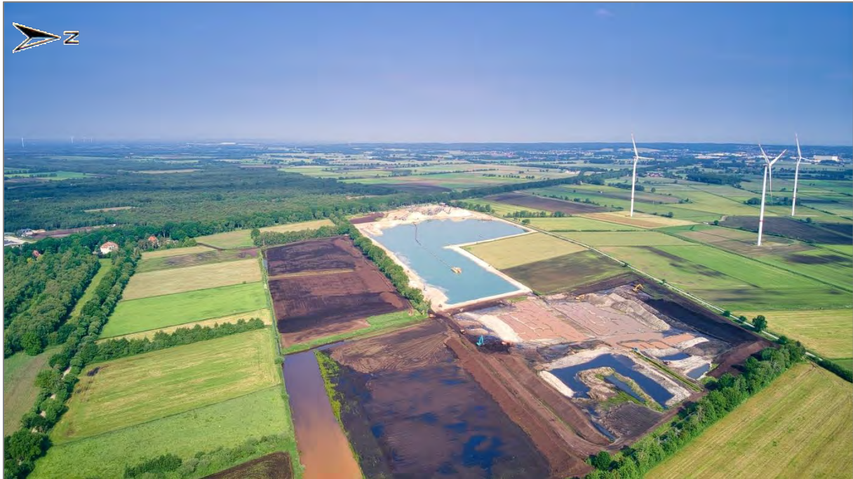
Abbildung 2: Stand des Abbaus im Kieswerk Schwegermoor am 09.06.2021. Die Aufnahme zeigt die Ausdehnung des Abbaugewässers und die Abtorfung der östlichen Teilflächen im nördlichen Abbaufeld.
