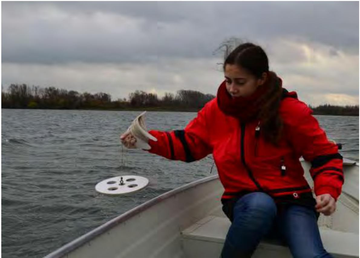
**Abbildung 3: Messung der Sichttiefe mittels einer Secchi-Scheibe, die an einer markierten Leine so weit in den See hinuntergelassen wird, bis sie nicht mehr sichtbar ist.**
