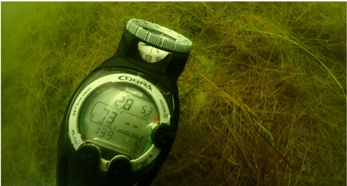
Abbildung 9: Anzeige des Tauchcomputers mit Kompass, hier im Flachwasser in 2,8 m Tiefe (Foto: van de Weyer).
